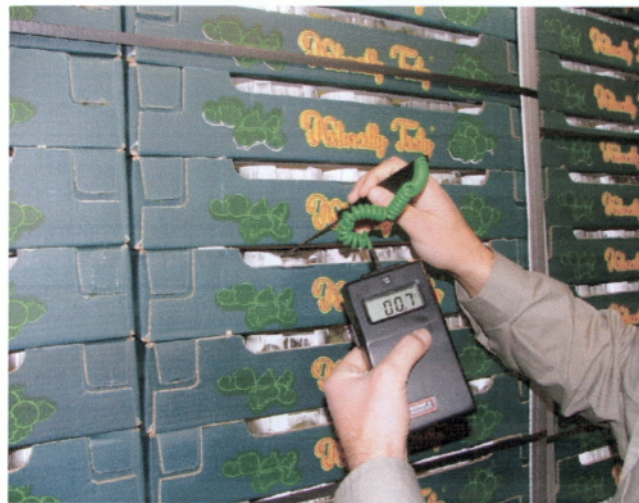
Εικόνα 7.1 Μέτρηση της θερμοκρασίας του σταφυλιού με τη βοήθεια θερμομέτρου χειρός Πηγή: Συσκευαστήριο Πασχάλης Α.Ε.
