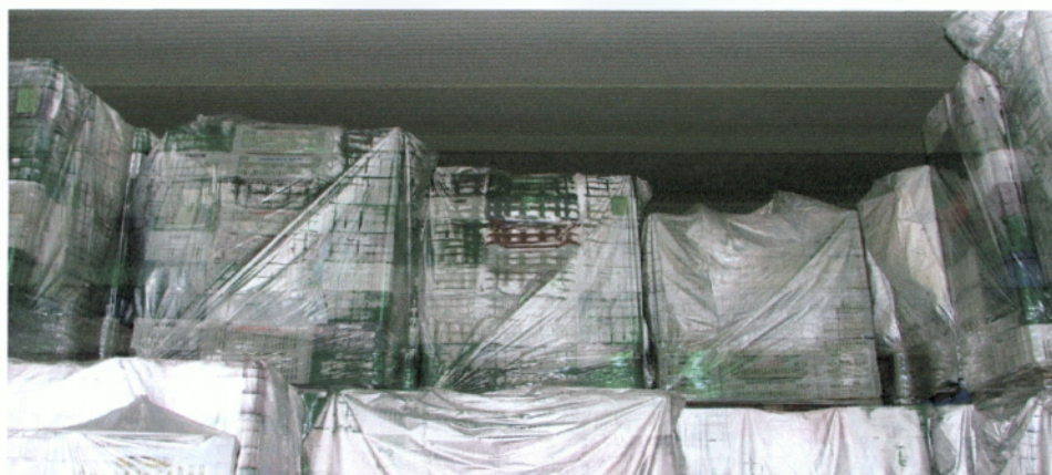
Εικόνα 8.1 Τύλιγμα παλετών με ειδικές μεμβράνες Πηγή: Συσκευαστήριο Πασχάλης Α.Ε.
