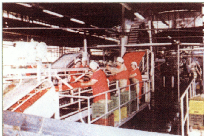
Εικ. 7 Ταινία διαλογής και προώθηση της τομάτας στο σπαστήρα (Αγγίδης, 2006).
