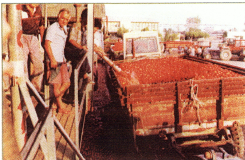
Εικ. 3 Υδραυλική εκφόρτωση τομάτας (Αγγίδης,2006)
