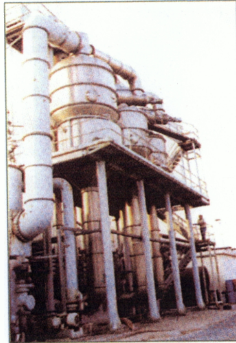
Εικ. 10 Συγκρότημα συμπυκνωτού χυμού τομάτας συνεχούς ροής (Αγγίδης, 2006).
