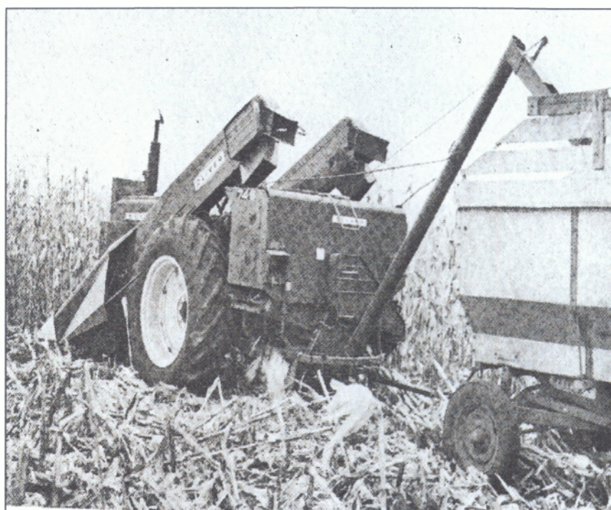
3.4)Μηχανή καλαμποκιού η οποία εκκοκκίζει στη συνέχεια τις ρόκες
