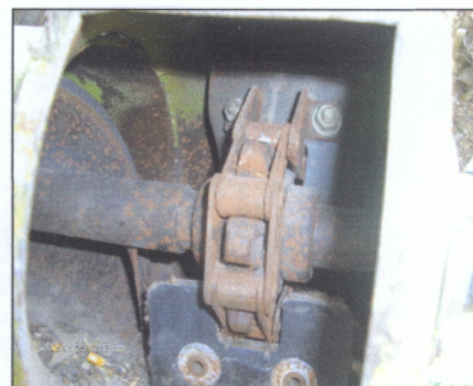
4.35) Το εσωτερικό του μηχανισμού κίνησης των επιστρεφόμενων
