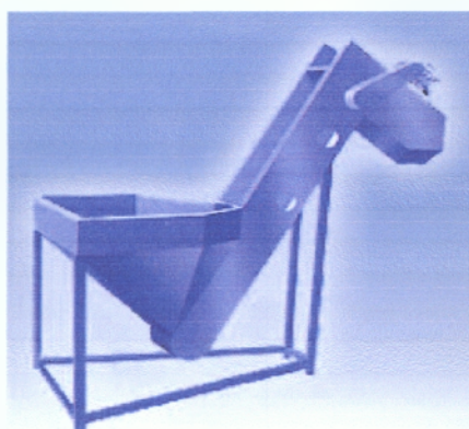
Εικ. 3 Μηχάνημα τροφοδοσίας του μηχανήματος τεμαχισμού
