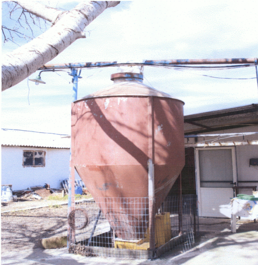
Εικόνα 6.7 Σιλό Ξηράς Περιόδου 2 τόνων Χοιροτροφικής Μονάδας Καρύγιαννη Νικόλαου
