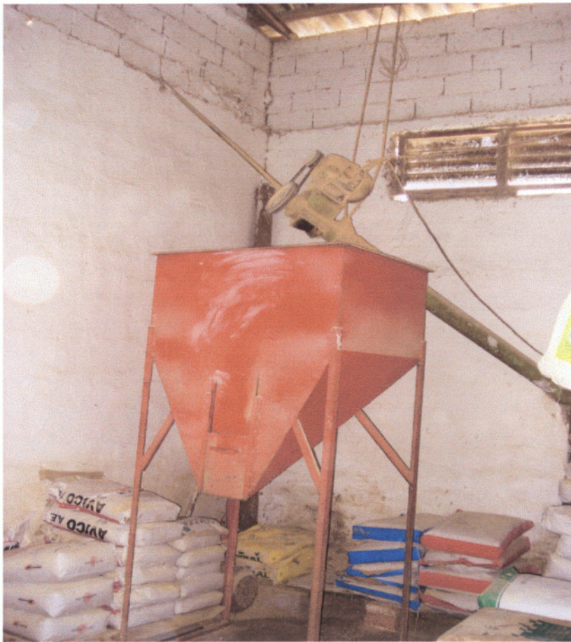
Εικόνα 6.12 Σιλό τροφοδοσίας έτοιμου μίγματος Χοιροτροφικής Μονάδας Καρύγιαννη Νικόλαου
