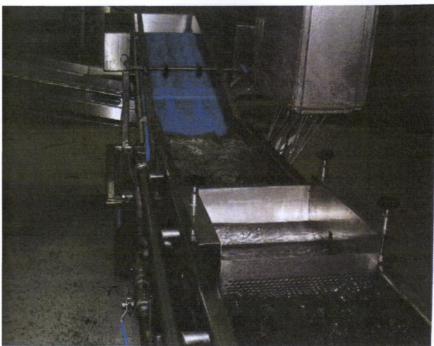
Εικόνα 13: Πλυστικό μηχάνημα (πηγή: Σπανού, 2006)
