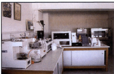
Εικόνα 5.1.3 : Συσκευές Ποιοτικού Ελέγχου όπως αμυλογράφος, φαρινογραφο, κλίβανο και ζυμοταχυγράφο
