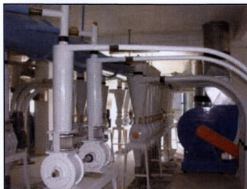
Εικόνα 2.1.5 : Μηχανισμός μεταφοράς του αλεύρου
