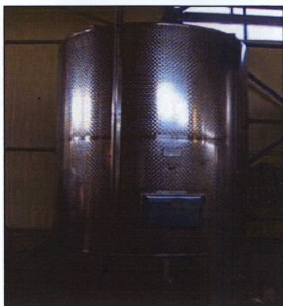
Εικ. 13 Δεξαμενή ζύμωσης
