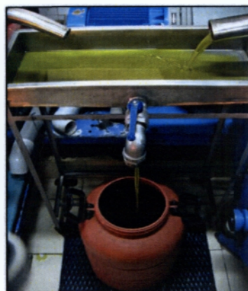
Εικόνα 2.6. Δοχείο ελαιολάδου κατασκευασμένο από ειδικό πλαστικό, εγκεκριμένο για χρήση τροφίμων.
