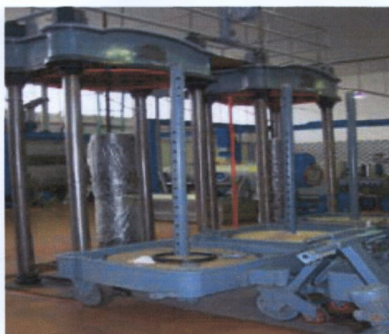
Εικόνα 12. Πιεστήρια και λεκάνες φόρτωσης ελαιοδιαφραγμάτων.
