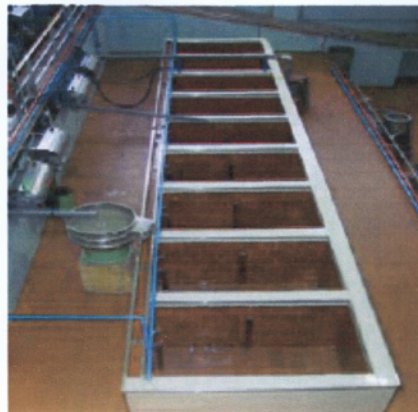
Εικόνα 15.-Συστοιχία δεξαμενών διαχωρισμού ελαιολάδου από φυτικά υγρά
