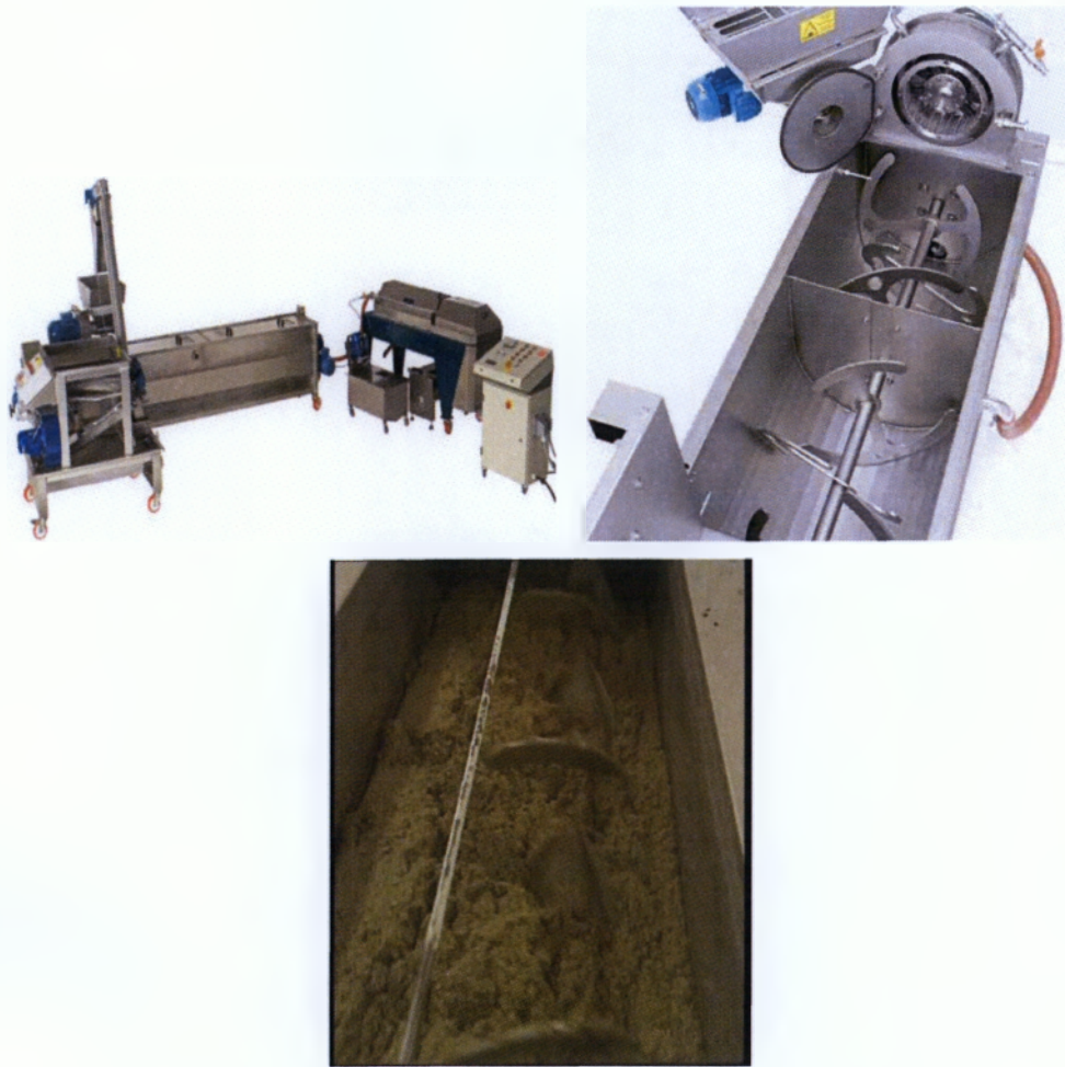
Εικόνα 5: Σπαστήρας – Μαλακτήρα ελαιοκάρπου
