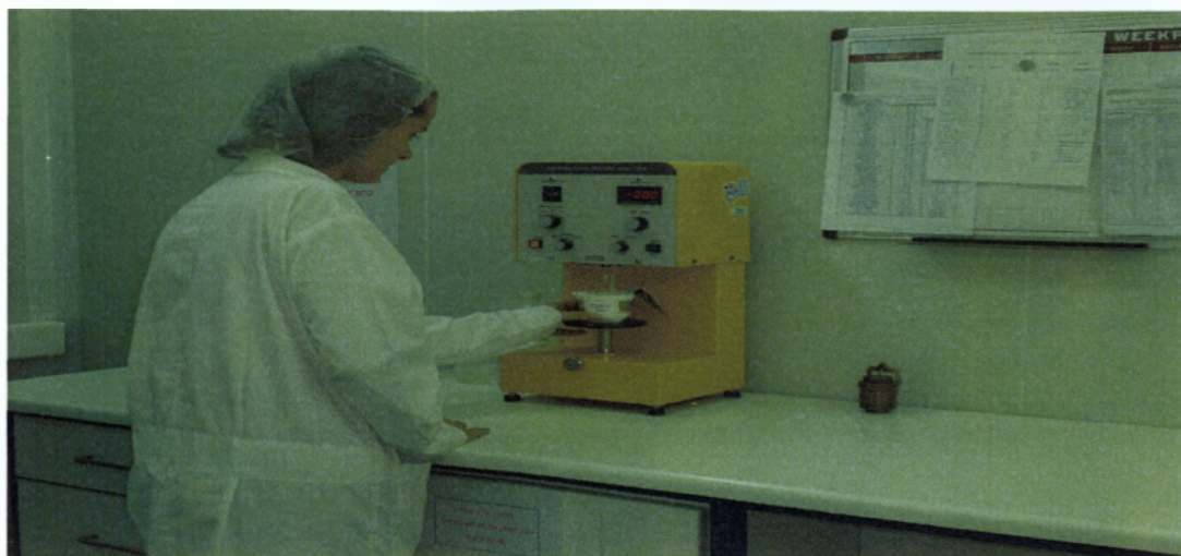
3.Μέτρηση ιξώδους με τη συσκευή STEVENS.
