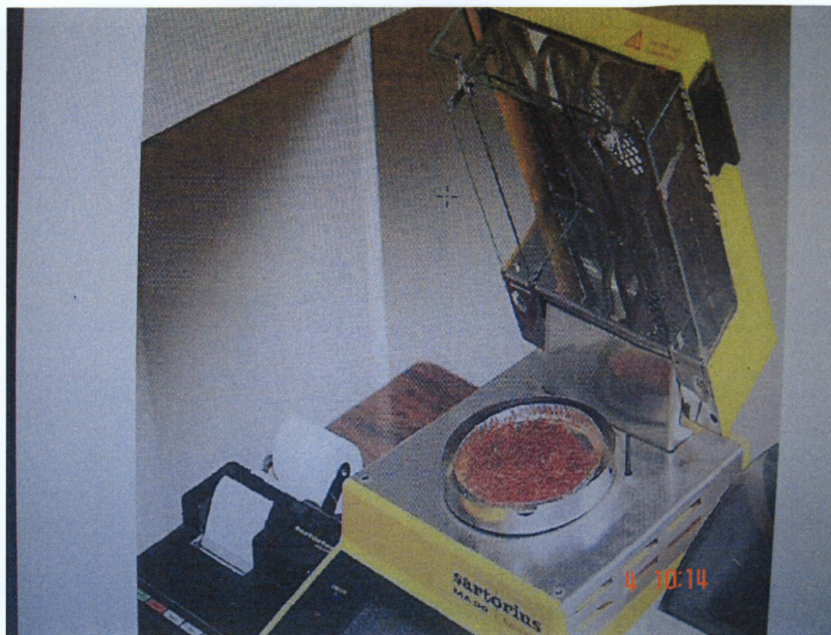
Εικόνα 21: Συσκευή για ποιοτικό έλεγχο κρόκου. (Αναγκαστικός Συνεταιρισμός Κροκοπαραγωγών Κοζάνης)
