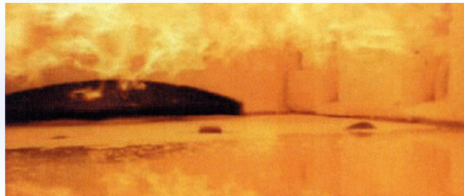
Εικόνα 4.1: οριζόντιος κλίβανος τήξης υαλομάζας
