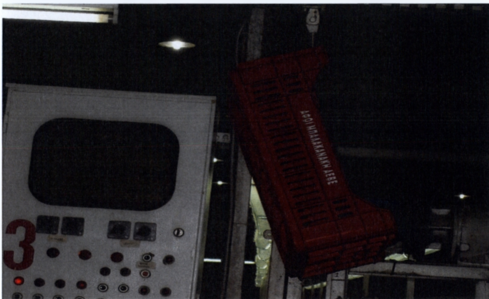
Φωτογραφία 9 : σύστημα μεταφοράς άδειων τελάρων
