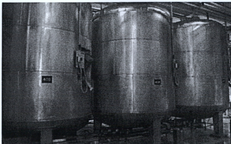
Εικόνα 4. Οι δεξαμενές μέσα στις οποίες συντελείται η προετοιμασία της λιπαρής φάσης των μαργαρινών. ( http://www.metadosi-ischios.gr/article.php?ID=127 )
