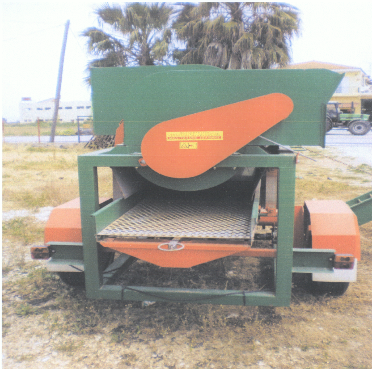
Εικόνα 6. Διαχωριστήρας Έλαιόκαρπου από Ελαιόκλαδα – Κόσκινο διαχωρισμού καρπού από κλαδιά
