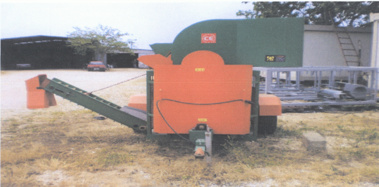
Εικόνα 8.: Διαχωριστήρας Ελαιόκαρπου από Ελαιόκλαδα – Τροφοδοσία κίνησης μέσω ΡΤΟ του τρακτέρ – Μεταφορική ταινία.
