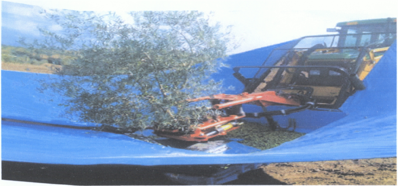
Εικόνα 12.: Παρελκόμενος δονητής τοποθετημένος στο μπροστινό μέρος του τρακτέρ
