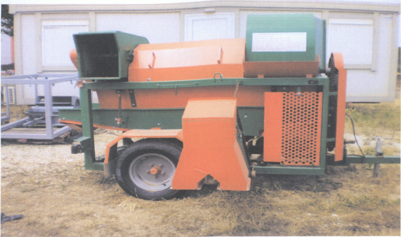
Εικόνα 7.: Διαχωριστήρας Ελαιόκαρπου από Ελαιόκλαδα – Μεταφορική ταινία, Στόμιο γεμίματος σακού και στόμιο εξαγωγής θρυμματισμένων κλαδιών
