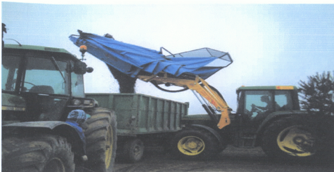
Εικόνα 13.: Παρελκόμενος δονητής τοποθετημένος στο μπροστινό μέρος του τρακτέρ: Ξεφόρτωμα του καρπού της ελιάς μέσω της «Πόρτας» του συλλέκτη
