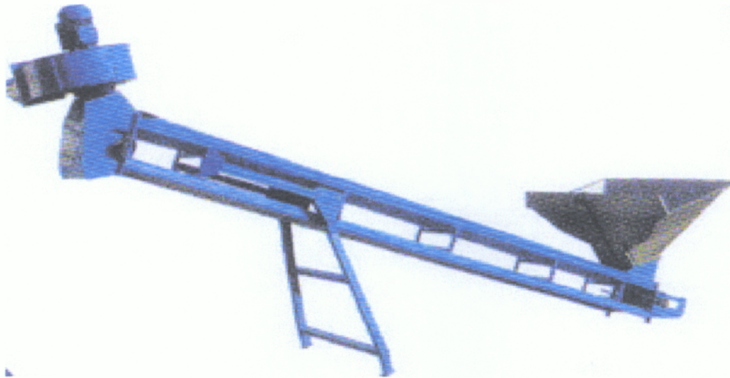
Εικόνα 18.: Χοάνη υποδοχής – Αναβατόριο – Αποφυλλωτήριο
