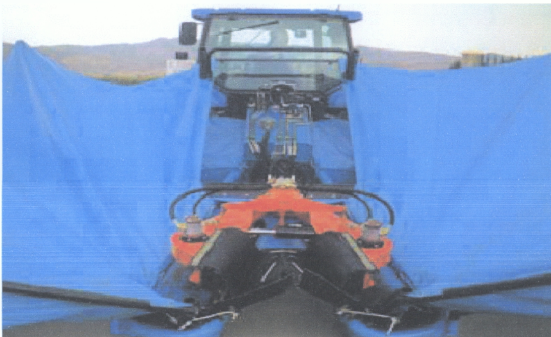
Εικόνα 11.: Παρελκόμενος δονητής τοποθετημένος στο πίσω μέρος του τρακτέρ
