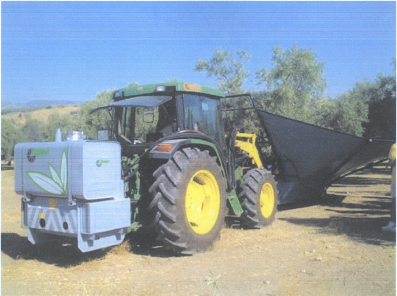
Εικόνα 14.: Παρελκόμενος δονητής τοποθετημένος στο μπροστινό μέρος του τρακτέρ: Υδραυλικό κέντρο
