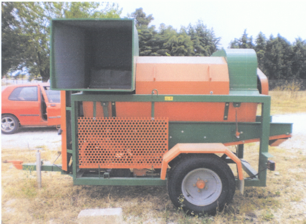
Εικόνα 5.: Διαχωριστήρας Ελαιοκάρπου από Ελαιόκλαδα – Στόμιο τροφοδοσίας ελαιόκλαδων.
