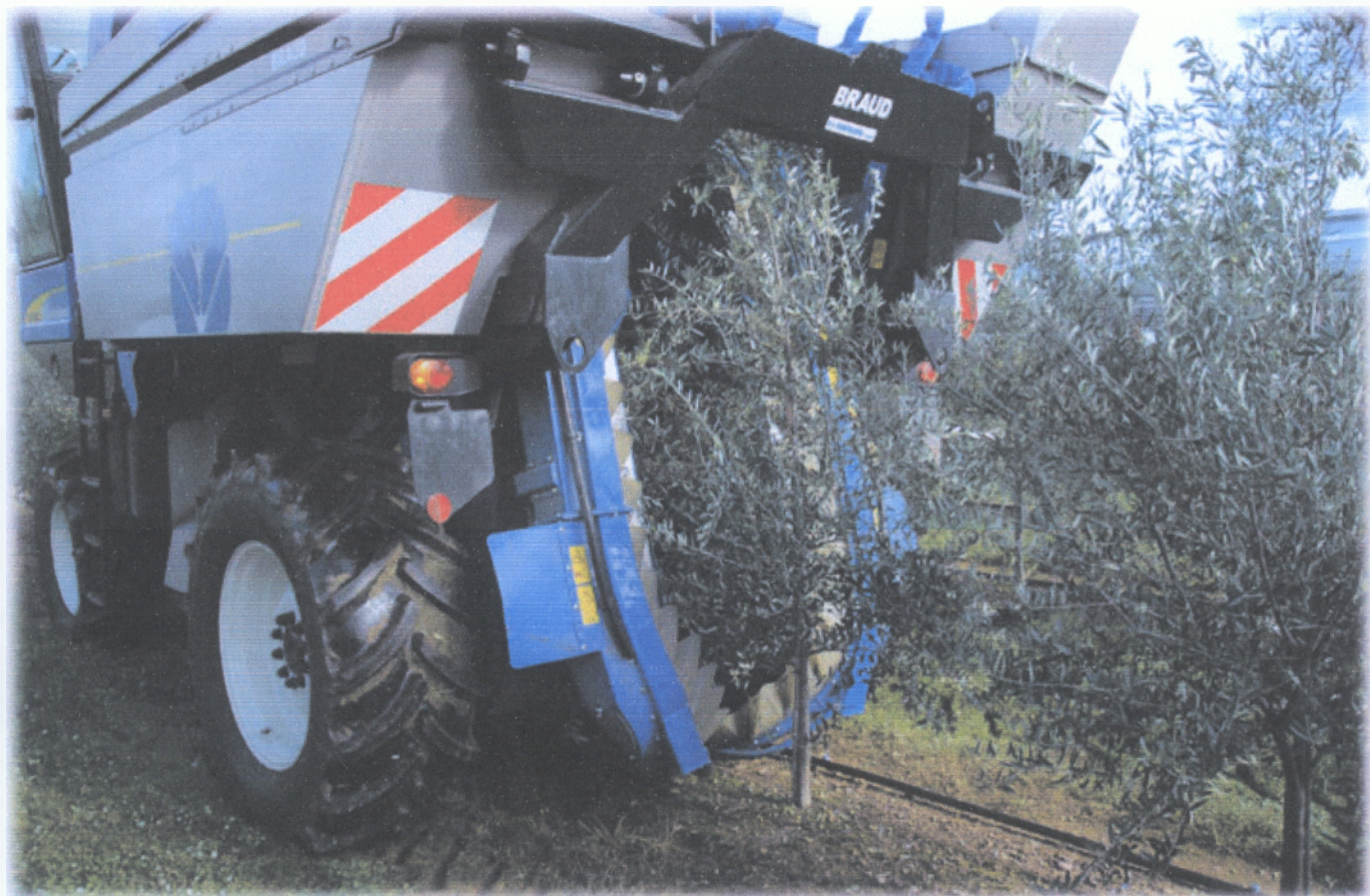
Εικόνα 17.: Δομητής κρούσης: Σύστημα δόνησης για συλλογή καρπού σε υπέρπυκνης φύτευσης καλλιέργειας ελιάς
