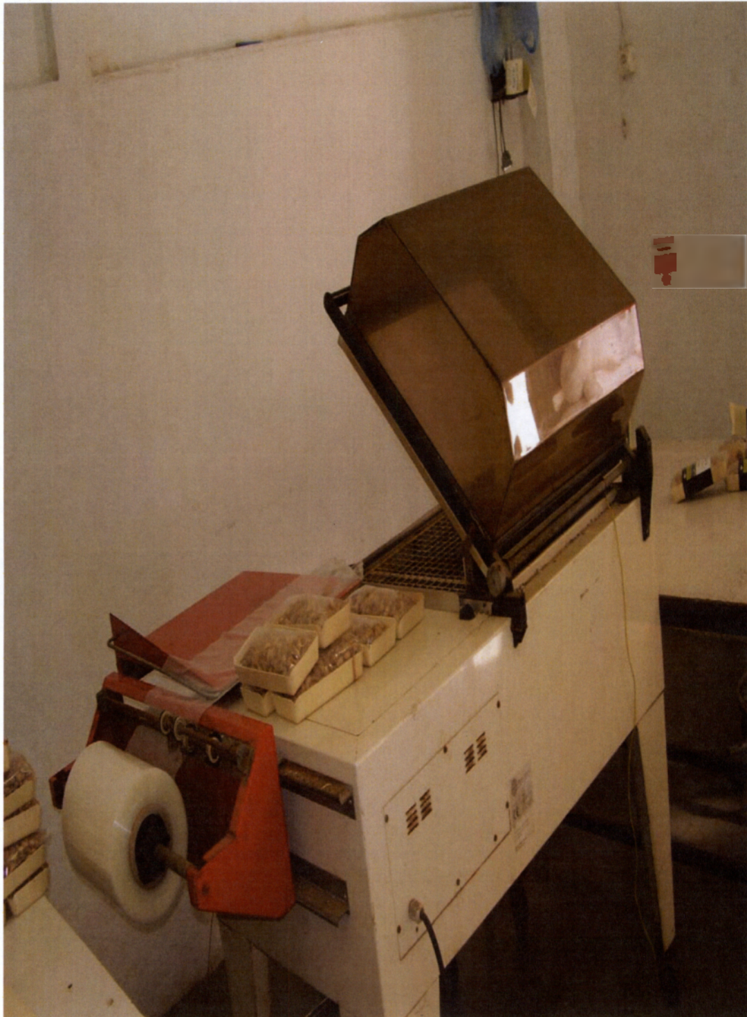
Εικ.21: Συσκευαστική Μηχανή (Vacuum). (Πηγή: Εργοστάσιο Φαρμάκης).
