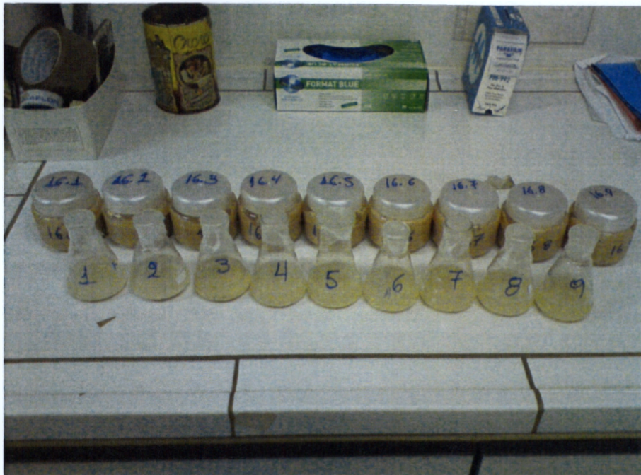
Εικόνα 4.7: Ο Κανονισμός απαιτεί τη δημιουργία εννέα δειγμάτων στα οποία αναγράφεται ο αριθμός του δείγματος και του υποδείγματος
