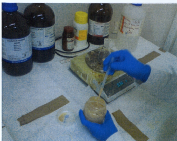
Εικόνα 4.2: Απαιτείται συνεχώς ανακάτεμα του ομογενοποιημένου δείγματος ώστε η ποσότητα που λαμβάνεται να αντιπροσωπεύει το αρχικό δείγμα.
