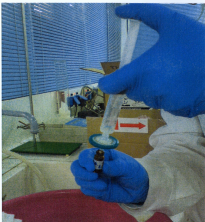
Εικόνα 4.10: Στη βάση του μικροφίλτρου τοποθετείται το φιαλίδιο το οποίο γεμίζει με την πίεση που ασκείται από την σύριγγα η οποία αναγκάζει το δείγμα σε δεύτερη διήθηση. Το φιαλίδιο πωματίζεται και οδηγείται στον αυτόματο δειγματολήπτη.
