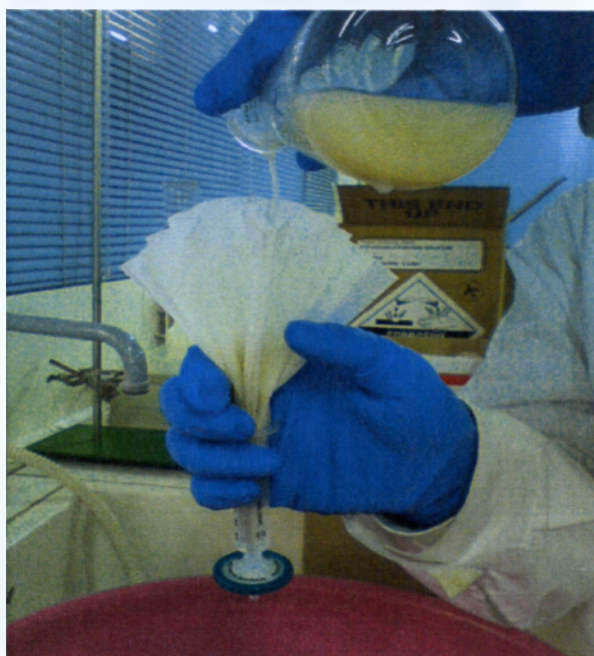
Εικόνα 4.9: Διπλή διήθηση του δείγματος. Το δείγμα αρχικά αφού αναδευτεί περνά από πτυχωτό ηθμό και στη συνέχεια από μικροφίλτρο.
