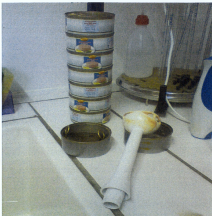
Εικόνα 4.1: Ομογενοποίηση δείγματος τόνου
