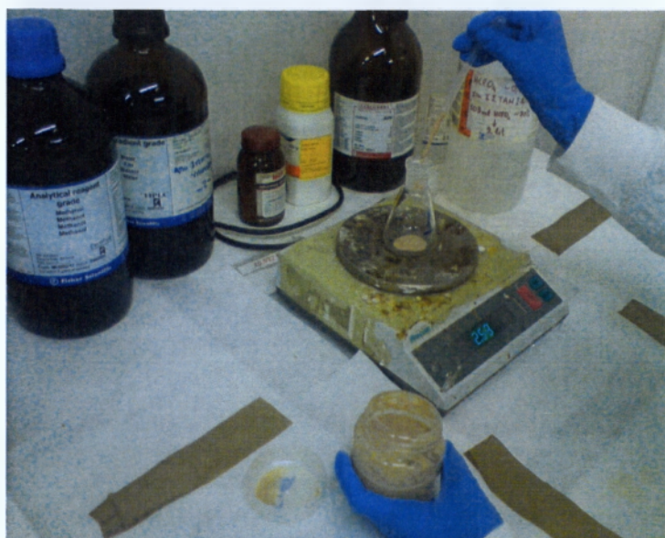
Εικόνα 4.3: Προσθέτονται μέσα στην εσφυρισμένη κωνική ποσότητα ομογενοποιηθέντος δείγματος m=5\text{gr}
