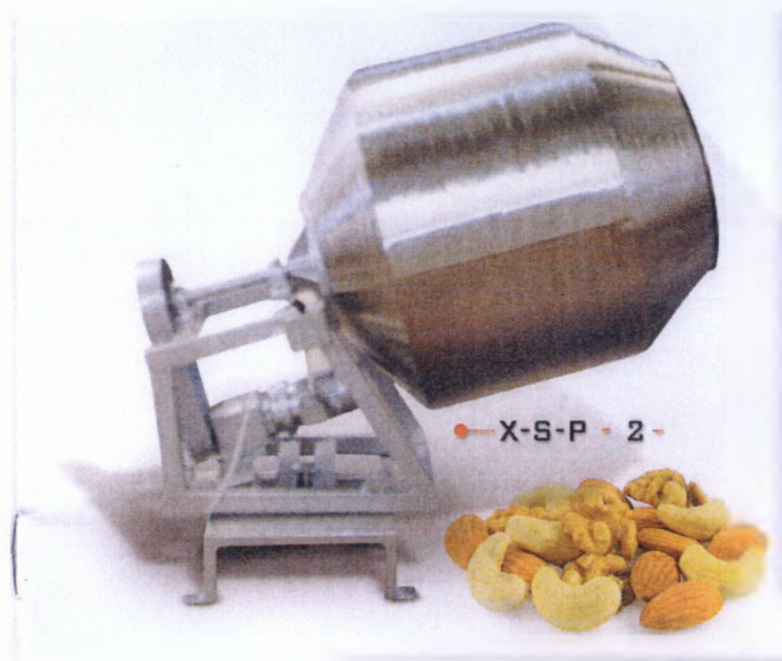
Εικόνα 11. Αναδευτήρες αλατίσματος(μηχανήματα Μικρόπουλος)
