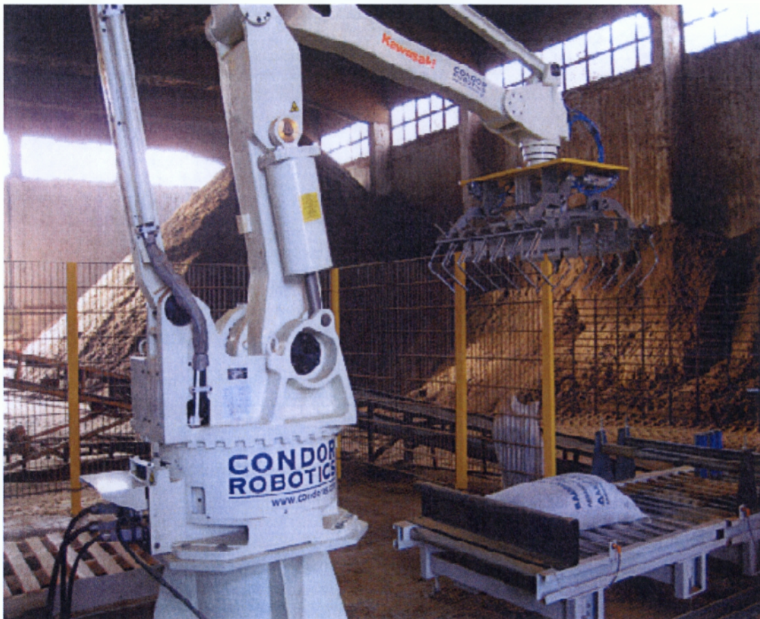
Εικόνα 15: Ένα πλήρες σύστημα παλετοποίησης
