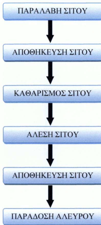
Σχήμα 4: Διάγραμμα Ροής παραγωγικής διαδικασίας αλεύρων πολυτελείας και ειδικών χρήσεων από μαλακό σιτάρι (Γεωργόπουλος Θ., 2009)
