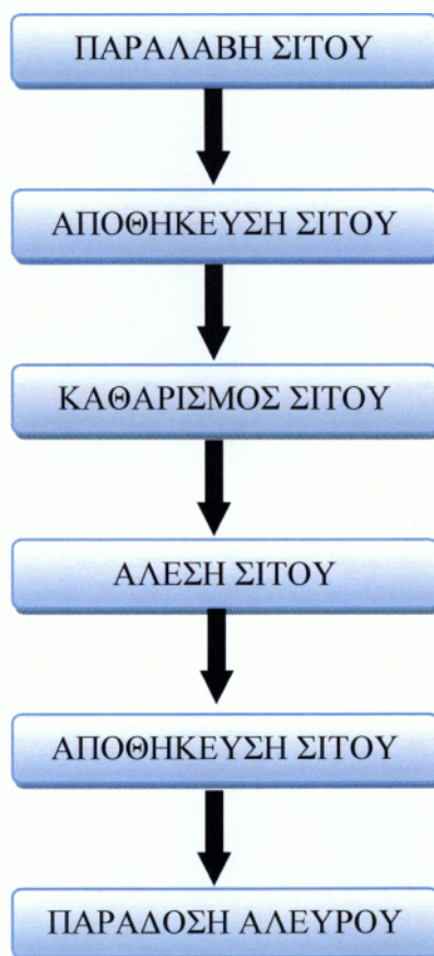
Σχήμα 2: Διάγραμμα Ροής παραγωγικής διαδικασίας αλεύρων από σκληρό σιτάρι (Γεωργόπουλος Θ., 2009)
