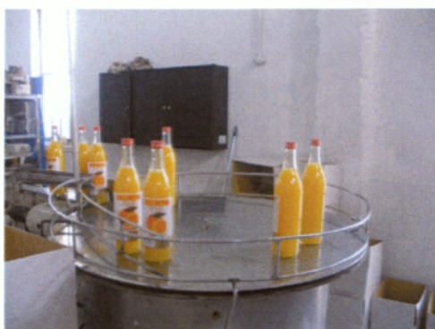
Εικόνα 52: Περιστρεφόμενος δίσκος συλλογής φιαλών ζαχαρούχου χυμού (προσωπική λήψη).
