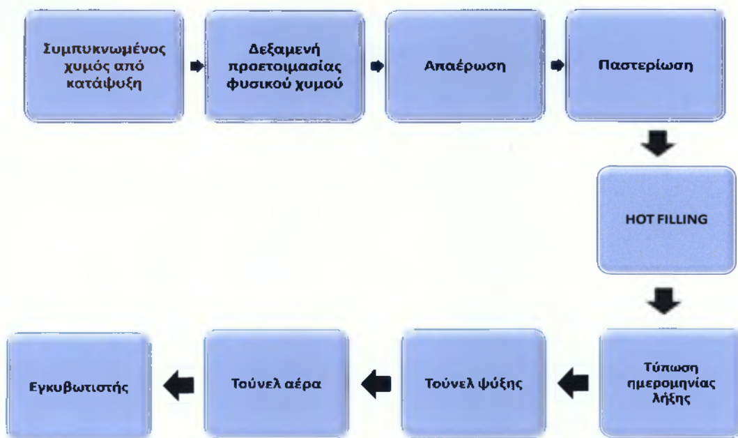
Σχήμα 2: Σχηματική αναπαράσταση του διαγράμματος ροής φυσικού πορτοκαλοχυμού.
