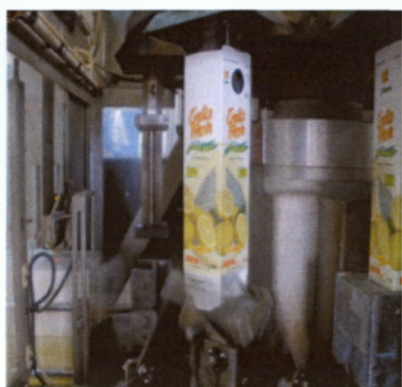
Εικόνα 32: Έμβολο σχηματισμού κουτιών (προσωπική λήψη).
