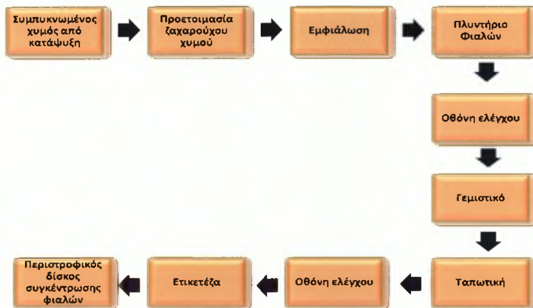
Σχήμα 3: Σχηματική αναπαράσταση διαγράμματος ροής ζαχαρούχου πορτοκαλοχυμού.
