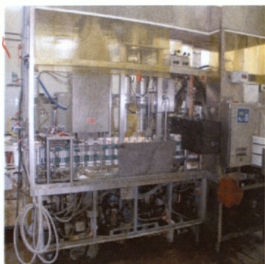
Εικόνα 31: Μηχανή Ελορακ σχηματίζει, γεμίζει και κλείνει αεροστεγώς τα κουτιά (προσωπική λήψη).
