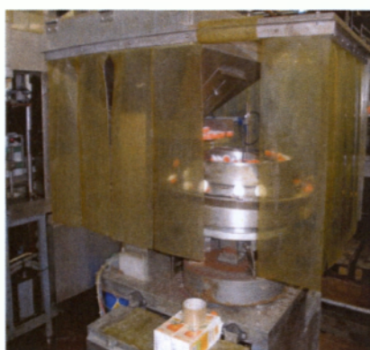
Εικόνα 33: Μηχανή τροφοδότησης καπακιών (προσωπική λήψη).
