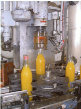
Εικόνα 49: Κεφαλή ταπωτικής και κοχλίας σε σχήμα αστέρα (προσωπική λήψη).
