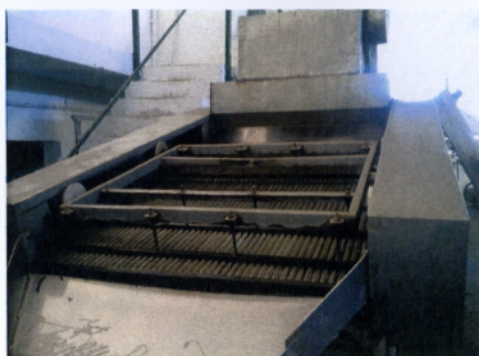
Εικόνα 38: Μηχάνημα αφαίρεσης ποδίσκου. (Πηγή : Λήψη από ψηφιακή μηχανή.)
