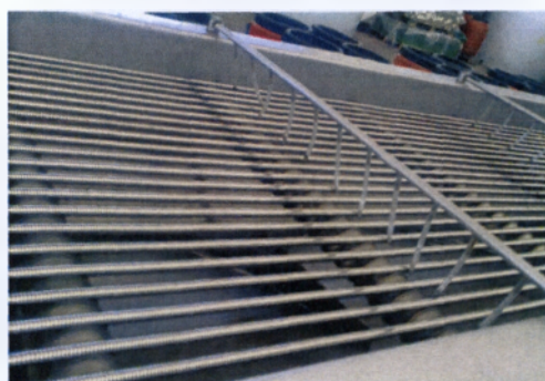
Εικόνα 43 : Ταξινομητής κατά μέγεθος (Πηγή : Λήψη από ψηφιακή μηχανή)
