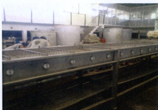
Εικόνα 39: Ταξινομητής ελιών με βάση το μέγεθος. ( Πηγή : Λήψη από ψηφιακή μηχανή.)
