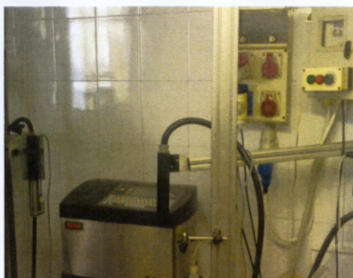
Εικόνα 50 : Εκτύπωση ημερομηνίας-λήξης και αριθμού παρτίδας ( Πηγή : Λήψη από ψηφιακή μηχανή.)
