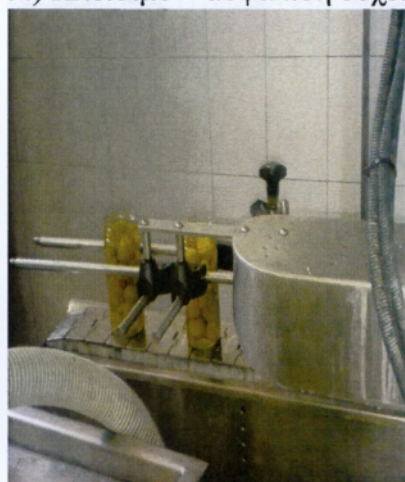
Εικόνες 48 και 49 : Κλειστικό βαζών (Πηγή : Λήψη από ψηφιακή μηχανή)
