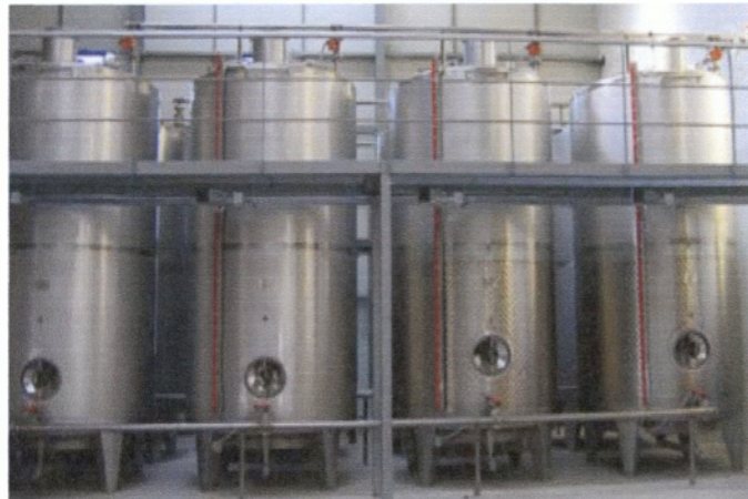
Εικόνα 5.2: Δεξαμενές αποθήκευσης ελαιολάδου από ανοξείδωτο χάλυβα
