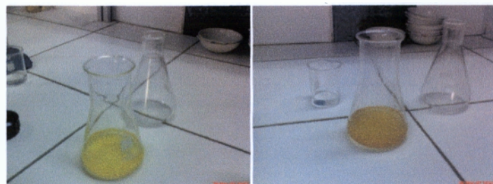
Εικόνα 6. Δείγμα πριν την ογκομέτρηση (α), Δείγμα μετά την ογκομέτρηση, (αλλαγή χρώματος) (β).
