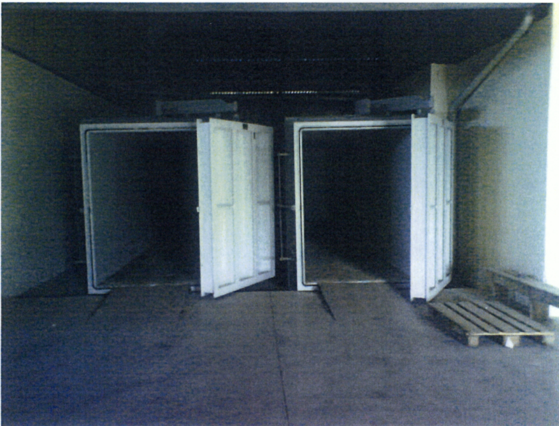
Εικόνα 27 VACUUM τύπου κοντέινερ όπου γίνεται η Απεντόμωση (Φωτογραφίες από ΣΥΚΙΚΗ)
