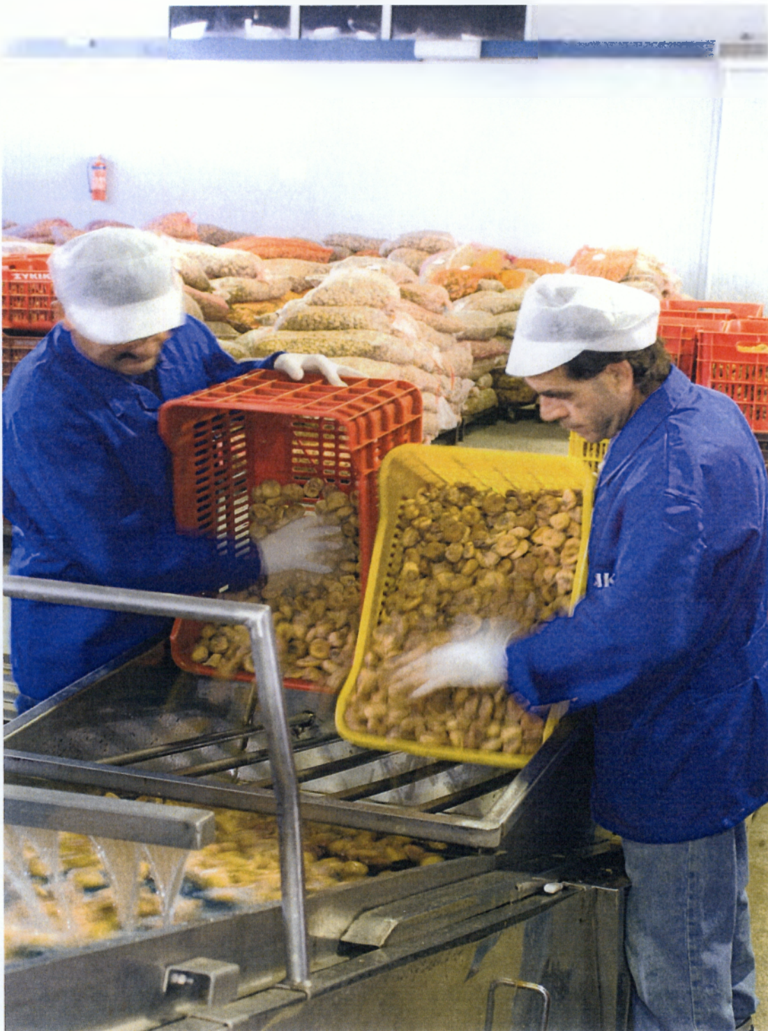
Εικόνα 18 γραμμή παραγωγής ΣΥΚΙΚΗΣ χοανη υποδοχής, αναβατόριο, πρόπλυση (Φωτογραφίες από ΣΥΚΙΚΗ)
