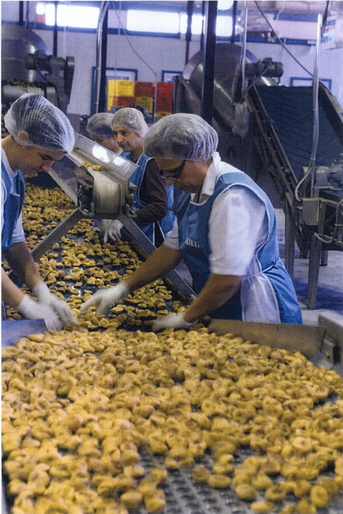
Εικόνα 19 γραμμή παραγωγής ΣΥΚΙΚΗΣ διαλογέας με κόσκινα, ταινία μεταφοράς, χειρονακτική διαλογή(Φωτογραφίες από ΣΥΚΙΚΗ)
