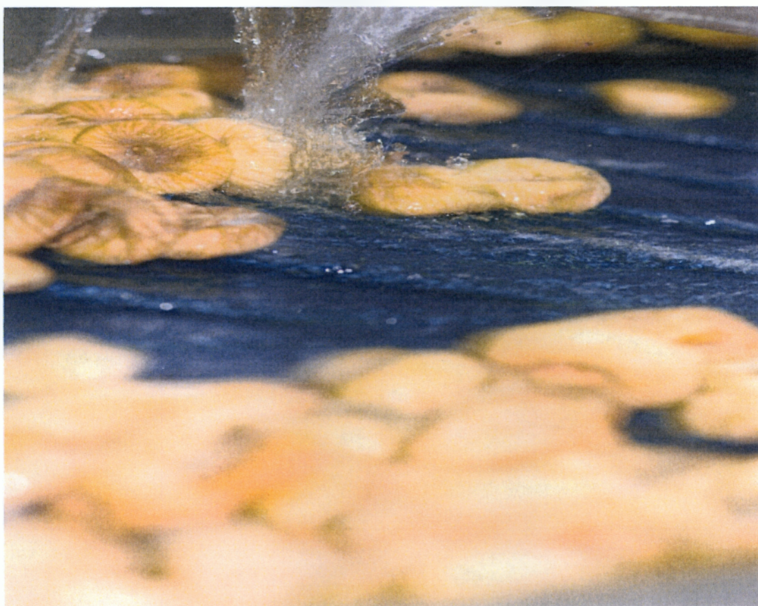
εικόνα 20 γραμμή παραγωγής ΣΥΚΙΚΗΣ ταινία μεταφοράς, πρόπλυση (Φωτογραφίες από ΣΥΚΙΚΗ)
