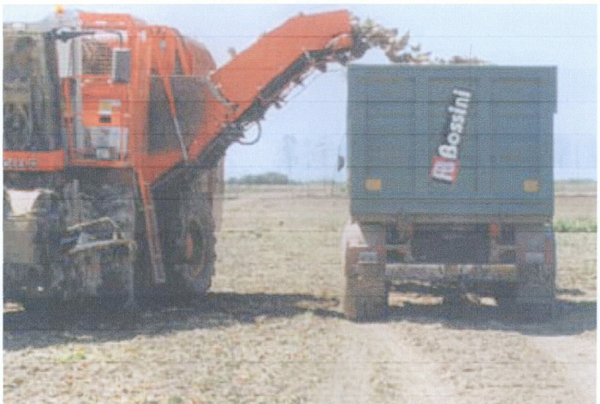
Εικ.13 Άδειασμα του κάδου της μηχανής στο φορηγό μεταφοράς
