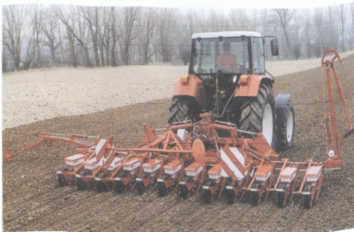
Εικ.5 Δωδεκάσειρη σπαρτική μηχανή τεύτλων ( www.ebz.gr )
