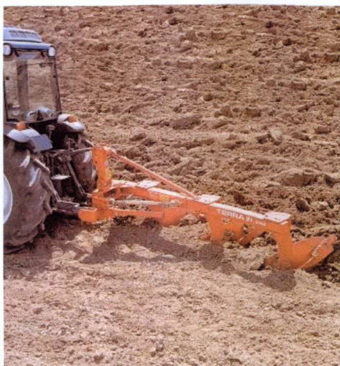
Εικόνα 7: Μεσαίου τύπου άροτρο για ιπποδυνάμεις από 35 έως 65 HP, με ρυθμιζόμενο πλάτος εργασίας
