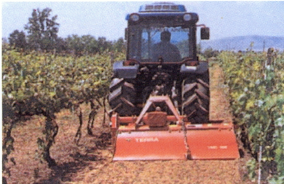
Εικόνα 8: Μεσαίου τύπου φρέζα με κεντρική ή πλευρική σύνδεση και υδραυλική μετατόπιση για ιπποδυνάμεις από 20 έως 70 HP
