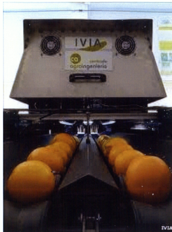
ΕΙΚΟΝΑ 3.2: Μηχάνημα με λαμπτήρες υπεριώδους ακτινοβολίας σε γραμμή παραγωγής πορτοκαλιών. (ΠΗΓΗ: vankateshtech.com)
