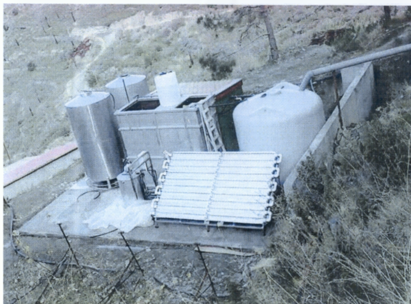
Εικόνα 4.1: Μονάδα προχωρημένης επεξεργασίας υγρών αποβλήτων οινοποιείου αποτελούμενη από Βιοαντιδραστήρα Μembrανών (MBR) και στάδιο Προχωρημένης Ηλιακής Οξείδωσης (SOLAR).
