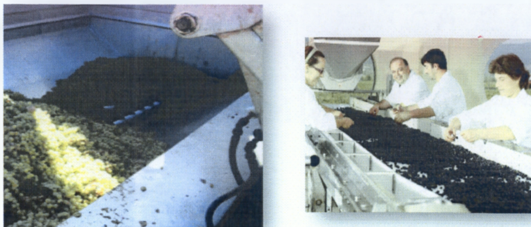
Εικόνα 1.2: Αριστερά, θραυστήρας (σταφυλοδόχος) και δεξιά, ιμάντας διαλογής σταφυλιών. (πηγή: http://www.nemeionestate.gr/items.php?catid=6 ).
