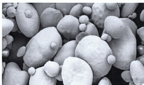
Εικόνα 2. Εικόνα από ηλεκτρονικό μικροσκόπιο σάρωσης για δείγμα αμύλου από σιτάρι. Εδώ φαίνεται ξεκάθαρα η διπλή κατανομή του μεγέθους [18].
