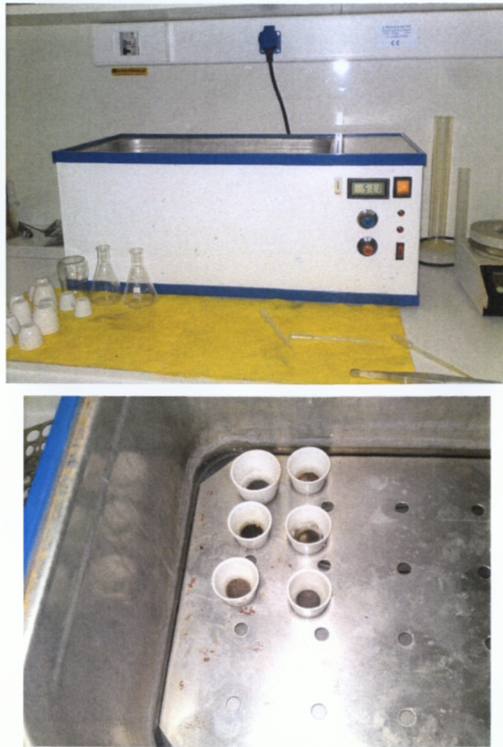
Εικόνα 17 : Υδατόλουτρο και κάψες με το δείγμα, εργαστήριο εδαφολογίας αιθ. 69
