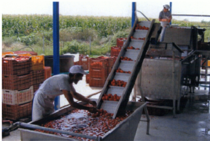
Εικόνα 5: Προκαταρκτικές εργασίες στην διαδικασία επεξεργασίας της τομάτας, πλύσιμο και διαλογή με τα χέρια.
