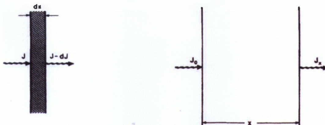
Σχήμα 3.10: Απεικόνιση της απορρόφησης ραδιενεργών ακτίνων \gamma που προσπίπτουν σε φύλλο πάχους dx με αρχική ένταση J και τελική ένταση J-dJ [3] .
