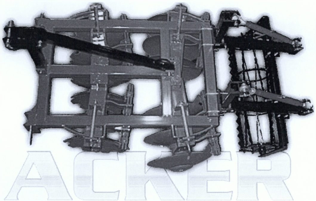
Εικ. 33 Δισκάροτρο σπαραγγιών μηχανήμα για την προ αναχωμάτωση. Ιδανικό για φρεσκάρισμα σαμαριών σε αμμώδη εδάφη. (Αγγίδης, 1991).
