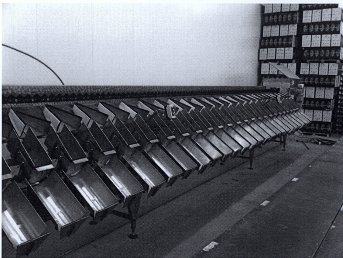
Εικ. 51. Μηχανή κοπής-διαλογής σπαραγγιού (έξοδοι μηχανής). (Δικές μου φωτογραφίες).
