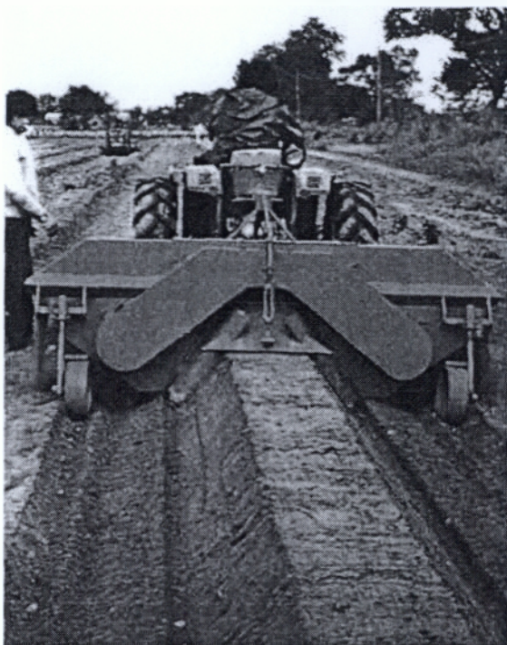
Εικ. 39 Φρέζα (φρεζοπρέσσα) σε κατασκευή σαμαριού. (Αγγίδης, 1991).
