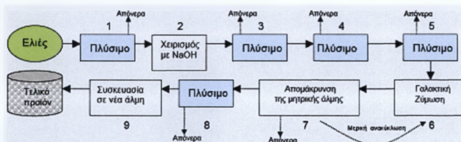
Εικόνα 48. Στάδια επεξεργασίας ελαιών με την ισπανική μέθοδο
