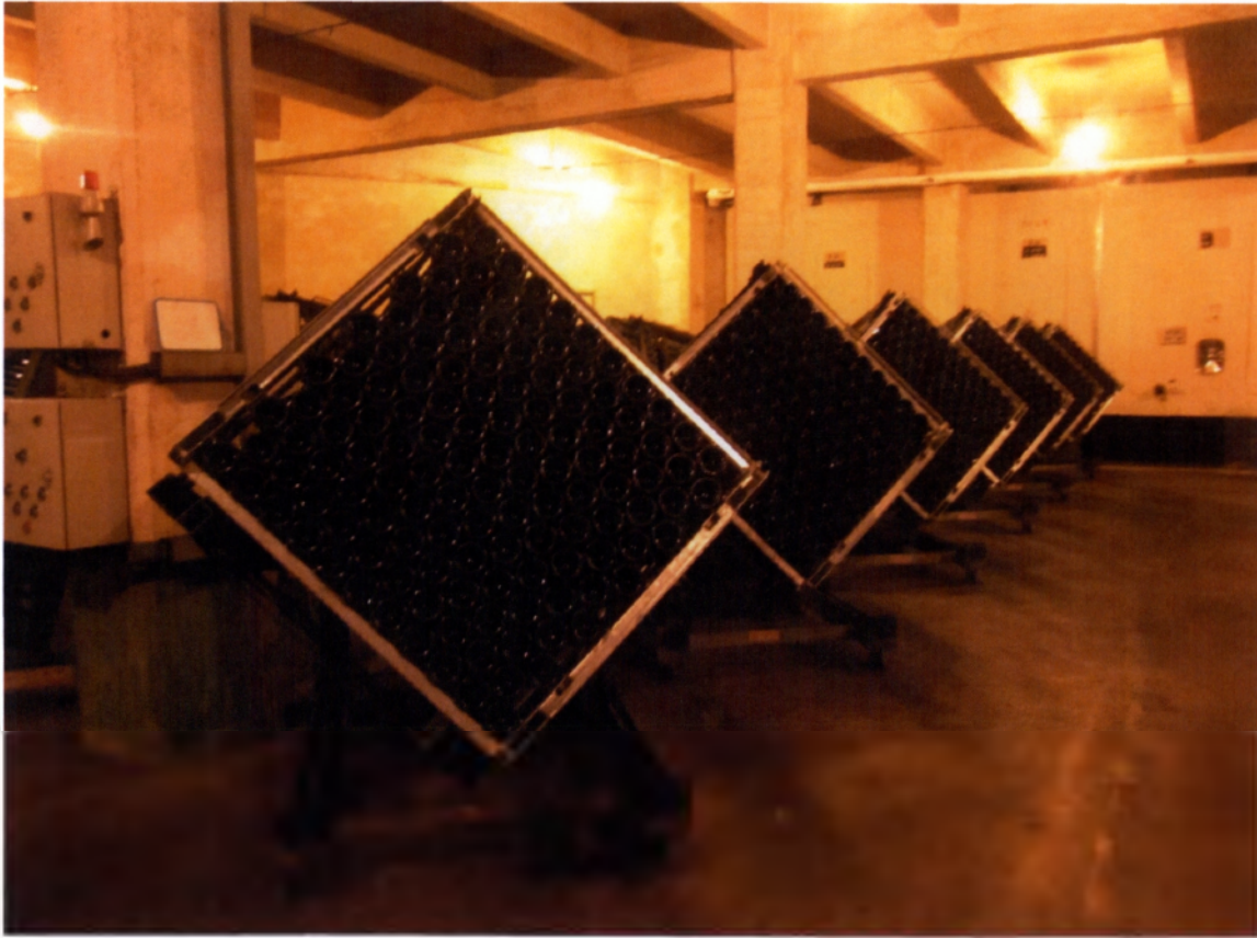
Εικόνα 3.7 Γυροπαλέτες για το αυτόματο remuage
