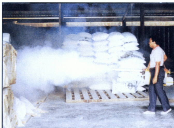
Εικόνα 28: Απεντόμωση με χρήση φορητής συσκευής ομιχλώδους νεφελώματος (puls FOG). (πηγή Σταμόπουλος 1995)
