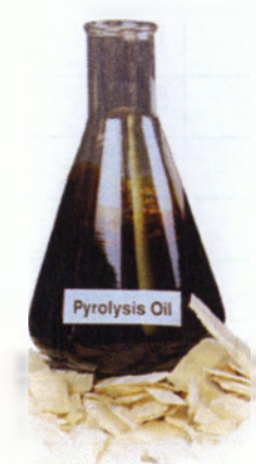
Σχήμα 6 Κωνική φιάλη που περιέχει βιοέλαιο ή αλλιώς έλαιο πυρόλυσης.
