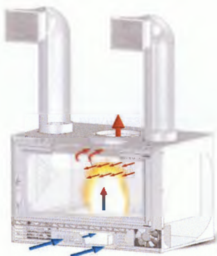
Σχήμα 1. Τυπικό ενεργειακό τζάκι
