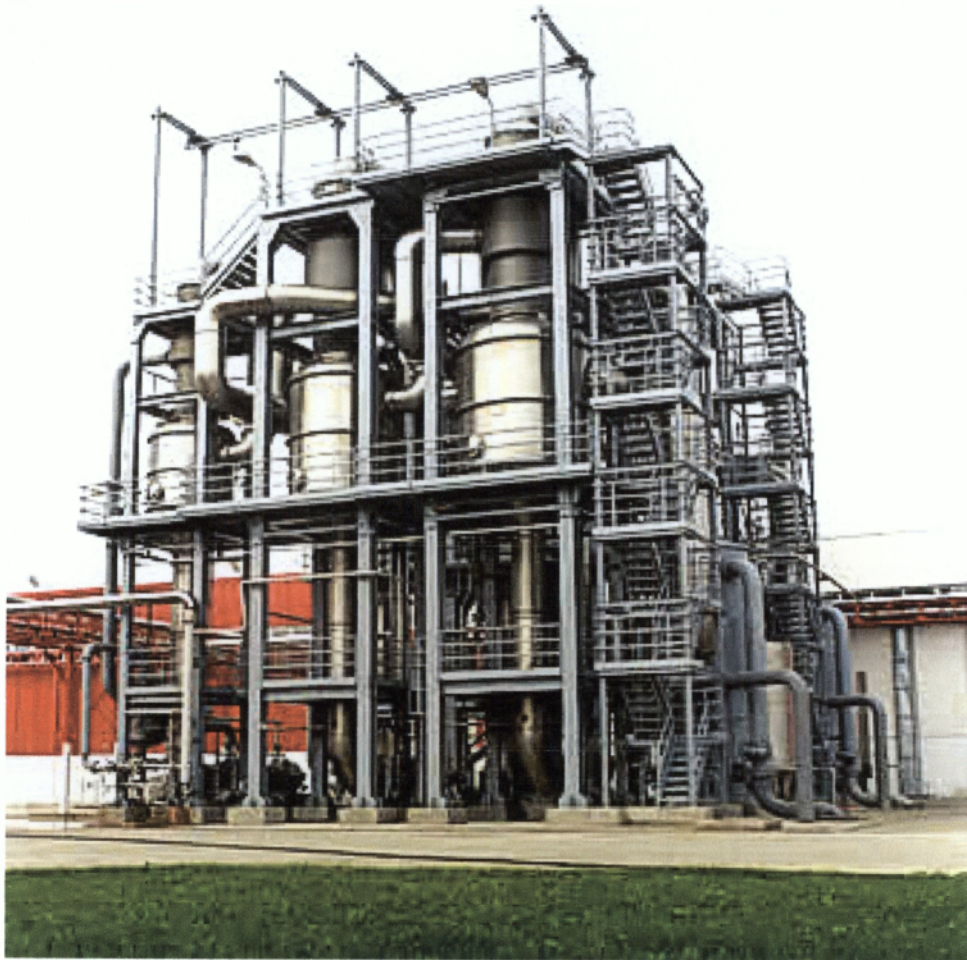
ΕΙΚΟΝΑ 19 VENUS Evaporator Triple Effect
