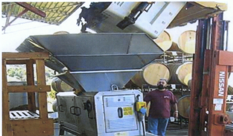
Εικόνα 7 Μηχάνημα θραύσης (σπαστήρας)
