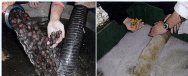
Εικόνα 2.1: Αντλία για τη μεταφορά ελιών ( http://www.mixanikiroi.gr/belloliva.html )
