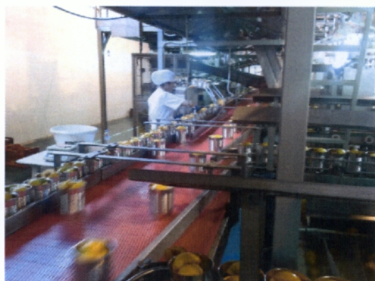
Ταινία Μεταφοράς Γεμάτων Κουτιών
