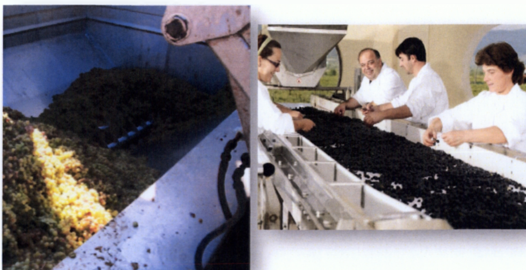
Εικόνα 2.2: Αριστερά, θραυστήρας (σταφυλοδόχος) και δεξιά, ιμάντας διαλογής σταφυλιών. (πηγή: http://www.nemeionestate.gr/items.php?catid=6 ).
