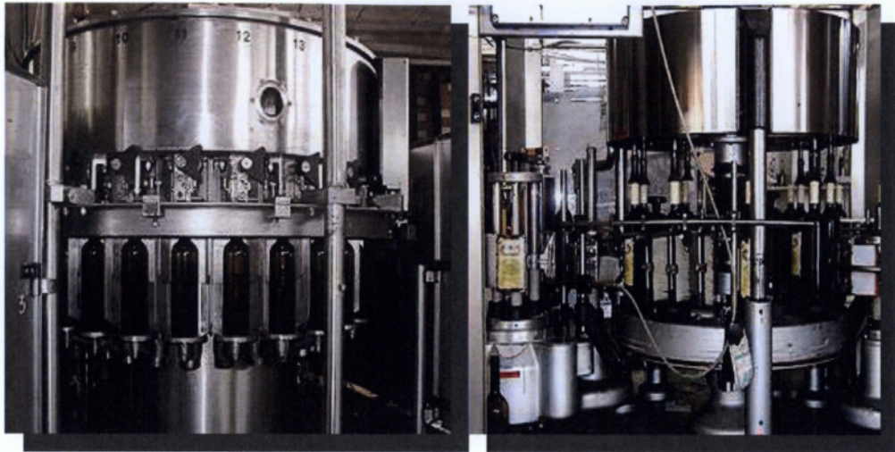
Εικόνα 2.7: Γέμισμα (αριστερά) και ετικετάρισμα (δεξιά) φιάλων οίνου.
