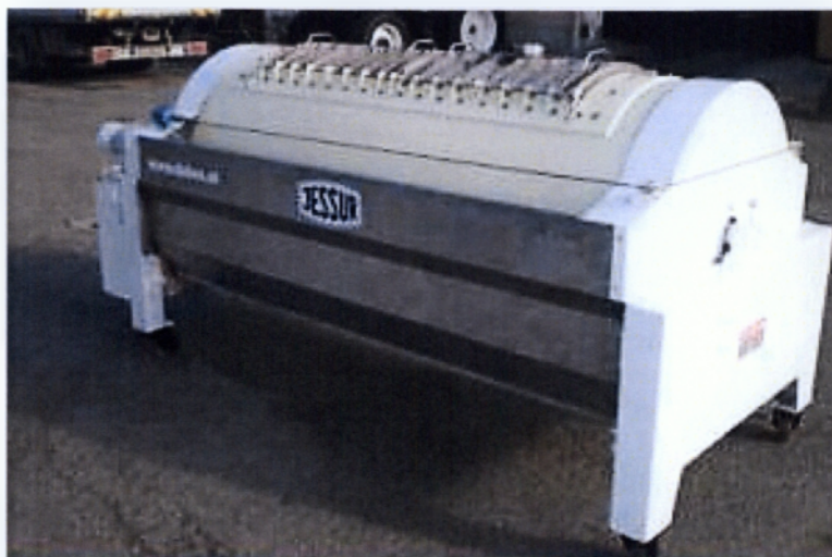
Εικόνα 2.4: Πρέσα Willmes (πηγή: http://www.technikboerse.com ).
