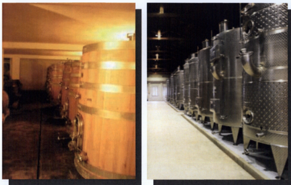
Εικόνα 2.5: Διαδικασία ζύμωσης. Αριστερά, δρύινα βαρέλια και δεξιά, ανοξείδωτες δεξαμενές ζύμωσης και σταθεροποίησης με ελεγχόμενο σύστημα ψύξης (πηγές: Αριστερά, http://kostisd.blogspot.com/2011/04/day.html και δεξιά, http://www.bibliachora.gr/ ).
