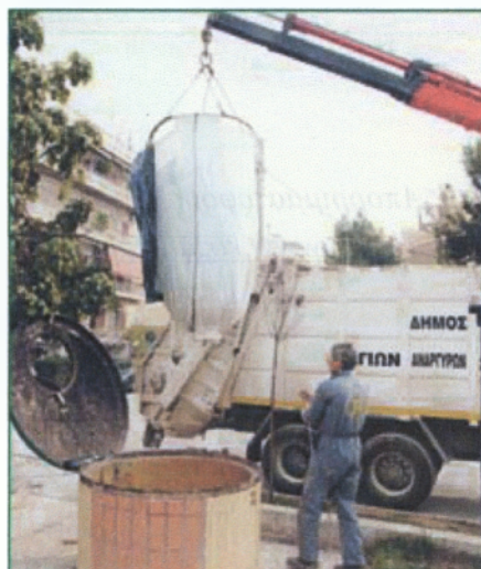
Εικόνα8: Τρόπος συλλογής αποβλήτων από βυθιζόμενο κάδο
