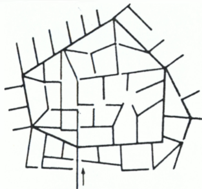
Σχ. 17 Κυκλικό σύστημα διανομής
