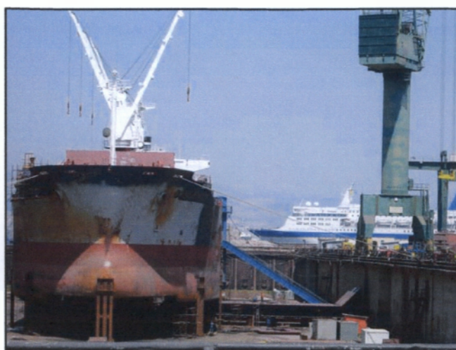
Ελασματοουργικές εργασίες σε πλοία στην χτιστή δεξαμενή των ναυπηγείων Σκαρμαγκά
