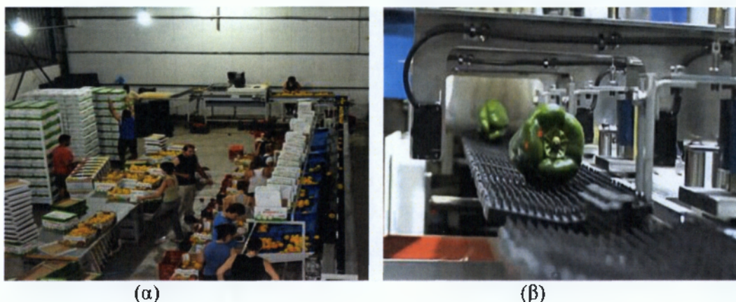
Εικόνα 3. α) γραμμή συσκευασίας - τυποποίησης πιπεριάς (olympias.gr), β) αυτόματος x-ray ταξινομητής (Anonymus, 2012).
