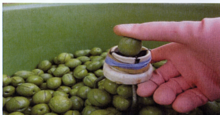
Εικόνα 16. Απεικόνιση εκπυρήνωσης με τη βοήθεια εκπυρηνωτή χειρός.
