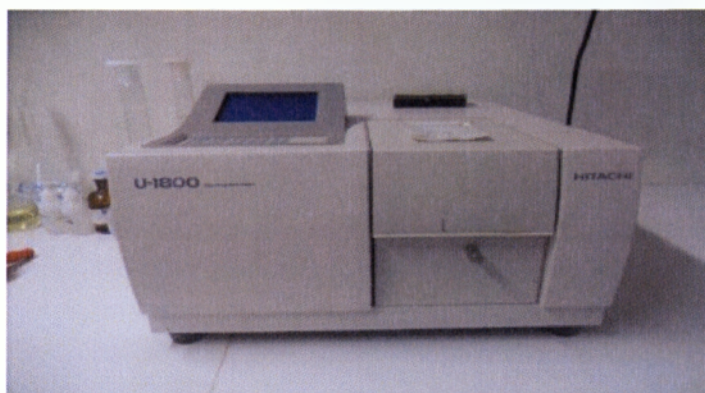
Εικόνα 21. Φασματοφωτόμετρο ορατής δέσμης στα 725nm.
