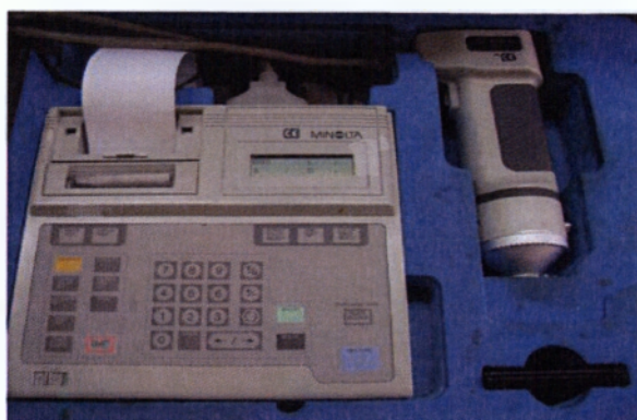
Εικόνα 20. Χρωματόμετρο Minolta (Model CR-300, Minolta Co Ltd Osaka)
