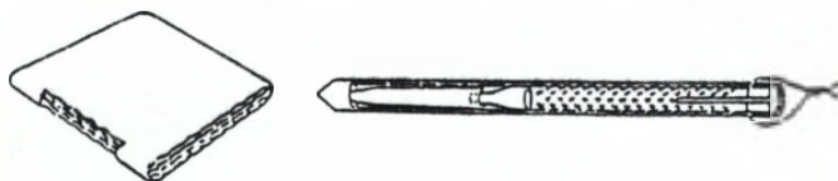
α. Κυματοειδές χαρτόνι β. Σόντα (για silos, σωρούς)
