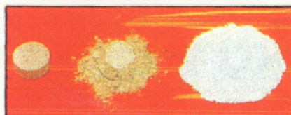
Επίπεδο δισκίο φωσφορούχου αργιλίου (αριστερά) μετά τη διάσπασή του (δεξιά).
